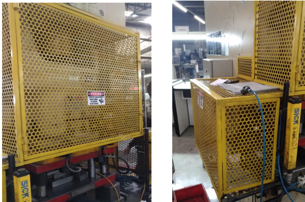
Figura 38: Enclausuramento do martelo e das zonas laterais da prensa
