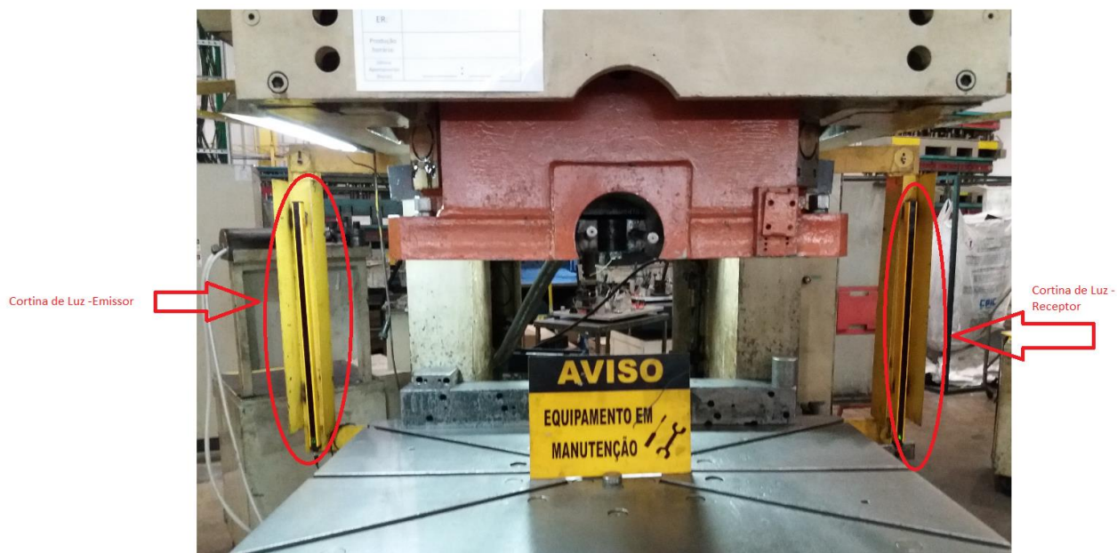
Figura 31: Sistema de proteção óptico da Prensa Mecânica PM 17
