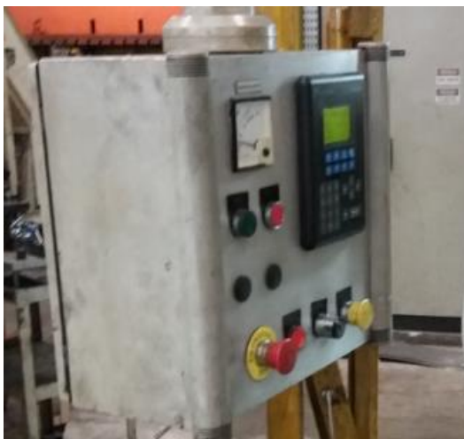
Figura 36: Instalação do Botão de emergência no painel da máquina
