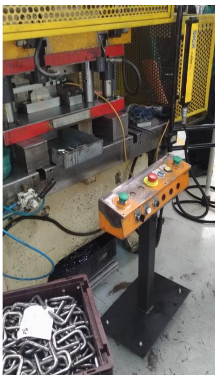
Figura 34: Sistema de Acionamento Bimanual Reformado da prensa PM17
